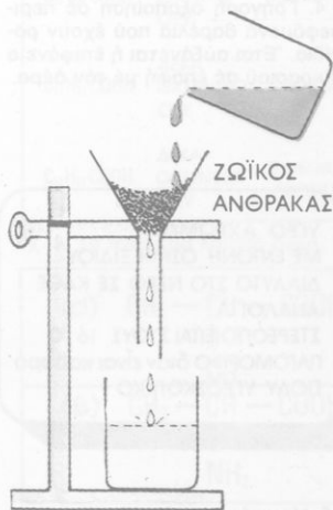
Σχ. 2. Άποχρωματισμός του ξιδιού.
