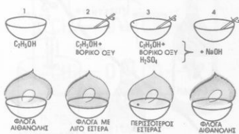
Σχ. 2. Σχηματισμὸς καὶ διάσπαση τοῦ βορικοῦ αἰθυλεστέρα.
