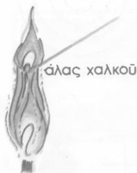
Σχ. 10. Πυροχημική άνίχνευση του χαλκού.
