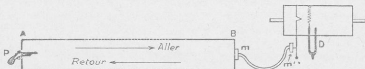
FIG. 156. — Schéma de la mesure de la vitesse du son dans un tuyau.
