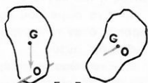
Σχ. 7: "Ίσορροπία άσταθής ( O κάτω από το G ). "Ίσορροπία αδιάφορη ( O και G συμπίπτουν).
