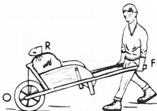
Σχ. 3: Σὲ ποιά θέση πρέπει νά τοποθετησοῦμε τὸ σάκκο, ὥστε ἡ δύναμη πού θά καταβάλουμε νά είναι ἡ ἐλάχιστη.
