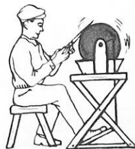
Σχ. 5: Το πετάλι (pedal) του άκονιστηριού είναι μοχλός με την κίνηση ενδιάμεση (Γ είδους πολλαπλασιαστής της μετατοπίσεως).
