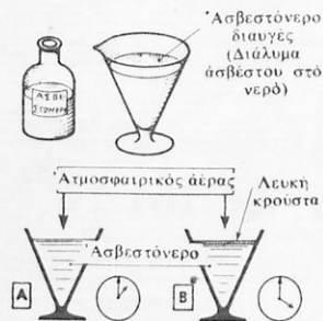
Σχ. 3: 'Η άσπρη κρούστα πού σχηματίζεται στην επιφάνεια του άσβεστόνερου φανερώνει την παρουσία του διοξειδίου του άνθρακα στην άτμόσφαιρα.
