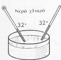
Βαθμολόγησις θερμομέτρου σὲ σύγκριση πρὸς ἄλλο.
