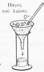
Βαθμολόγησις θερμομέτρου σὲ σύγκριση πρὸς ἄλλο.
