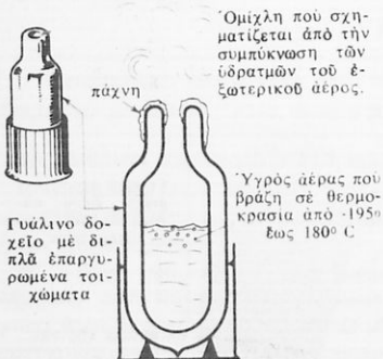
Σχ. 6: Δοχείο Dewar γιά τή διατήρηση υγρού άέρα.
