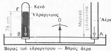
Σχ. 6. Ἡ στήλη τοῦ υδραργύρου ἰσορροπεῖ στήλη ἀέρα τής ἴδιας τομῆς και ὕψους ὅσο είναι τὸ πάχος τής ἀτμοσφαιρας.
