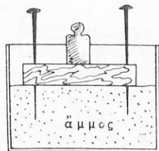
Σχ. 3: Ἡ πίεση ξερατάται ἀπὸ τὴν ἐπιφάνεια ἐπαφῆς, ὅπου ἐφαρμόζεται ἡ πιεστικὴ δύναμη.
