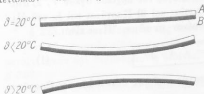
Σχ. 357. Τὸ σχῆμα τῶν διμεταλλικῶν ελασμάτων μεταβάλλεται μετὰ τῆς θερμοκρασίας.
