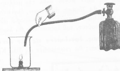
Σχ. 235. Τὸ διοξείδιον τοῦ ἀνθρακός, ὡς εἰδικῶς βαρύτερον τοῦ αέρος, παραμένει ἐντὸς τοῦ ποτηρίου.
