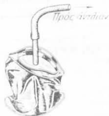
Σχ. 243. Ἐάν ἀφαιρέσωμεν τὸν ἐντὸς τοῦ δοχείου ἀέρα, τὸ τοῦτο συνθλίβεται.
