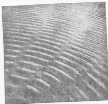
Σχ. 311 καὶ 312. Ἀποτέλεσμα τῆς συμβολῆς δύο κυμάτων ἐπὶ τῆς ἐπιφανείας τοῦ ὑδατος. Λεξιὰ: Μεγέθυνοις τμήματος τῆς ἀριστερᾶς εἰκόνης.
