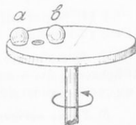
Σχ. 89. Κατὰ τὴν περιστροφὴν τῶν δίσκων, αἱ δύο σφαῖραι ἔχουν τὴν αὐτὴν γωνιακὴν ταχύτητα.
