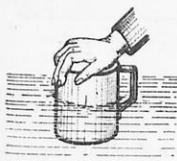
Σχ. 143. Ἐπὶ τῆς χειρὸς μας αἰσθανόμεθα σαφῶς τὴν ἐπὶ τοῦ δοχείου ἐξασκουμένην ἀνωσιν.
