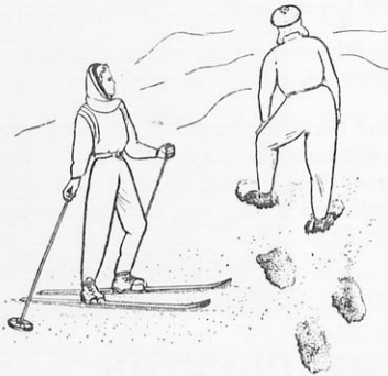
Σχ. 123. Ὅσον αὐξάνεται τὸ ἐμβαδὸν τῆς ἐπιφανείας, τόσον ἐλαττοῦται ἡ πίεσις ἐπὶ τῆς χιόνος.
